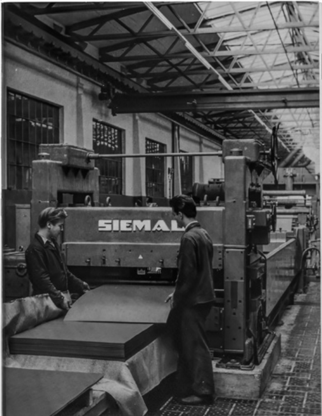
In dieser neuen Werkhalle erzeugt die Trierer Walzwerk AG den von ihr entwickelten Verbundwerkstoff Platal. Mit der neuen Fertigungsanlage ist es zum erstenmal in Deutschland gelungen, in großem Maßstab Kunststoff auf Stahlband kontinuierlich aufzutragen. Platal wird überall dort gebraucht, wo man mit ungelösten Korrosionsschutzproblemen kämpft und wo Farbe und Muster dem Stahlblech besondere Wirkung verleihen sollen.
