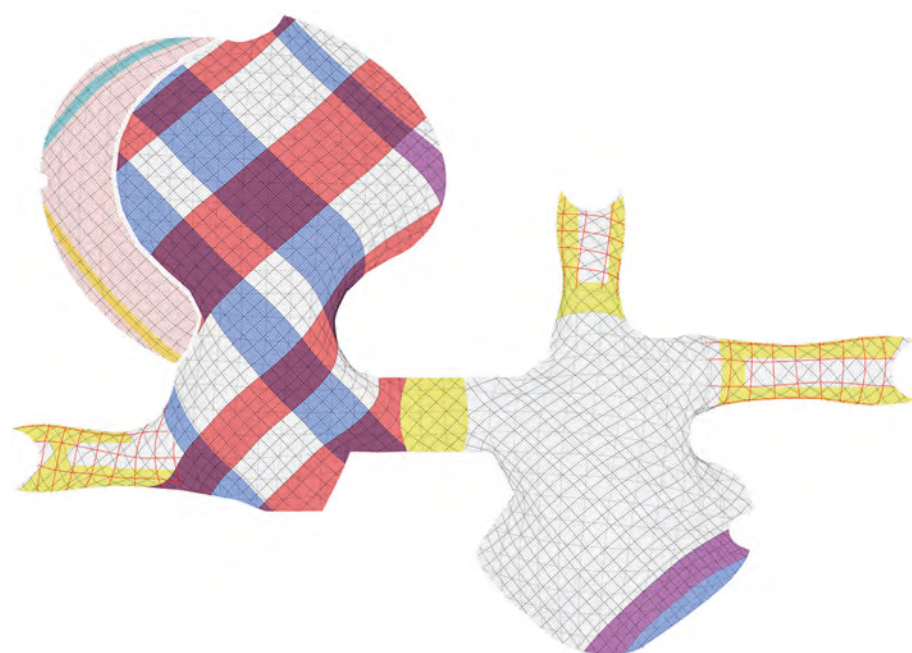
Bild 5 In der großen Halle werden Verstärkungsbänder angeordnet, in der kleinen Halle sind kaum Verstärkungen notwendig (Quelle: Fast + Epp) Reinforcement bands are positioned in the large hall, while in the small hall very few reinforcements are necessary
